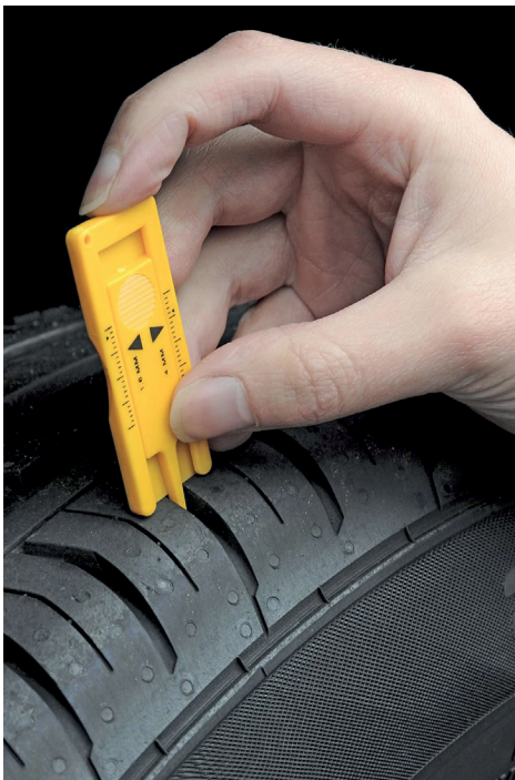
strumento universale per controllare l'usura degli pneumatici
